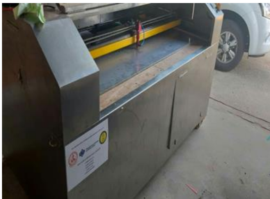
ภาพที่ 6.3.47 เครื่องตัดชิ้นงานแผ่นหนังด้วยเลเซอร์แบบอัตโนมัติ
