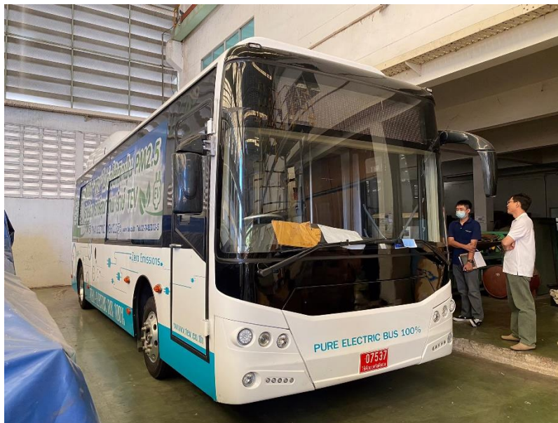
ภาพที่ 6.1.33 รถบัสไฟฟ้าชนิดโครงแบบ Monocoque ขนาดความยาว 10.5 เมตร ที่มา: ผู้พัฒนา
