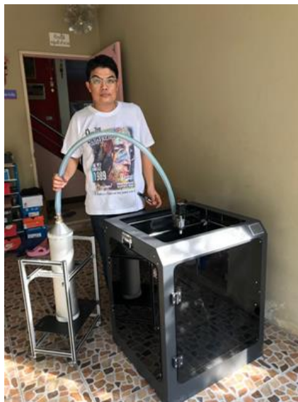
ภาพที่ 6.2.31 เครื่องขึ้นรูปชิ้นงานสามมิติความละเอียดสูงด้วยเรซินเหลว ที่มา: ผู้พัฒนา
