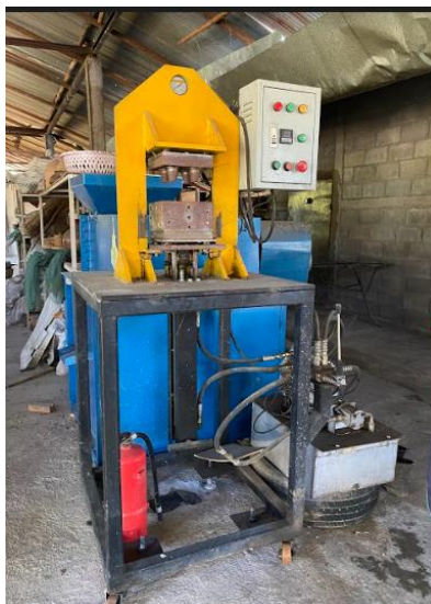
ภาพที่ 6.3.22 เครื่องผลิตกระถางเพาะชำจากเศษไม้มะม่วงในกระบวนการผลิตหัตถกรรมไม้มะม่วง ที่มา: วิทยาลัยชุมชนกลุ่มหัตถกรรมไม้มะม่วง ตำบลห้วยทราย
