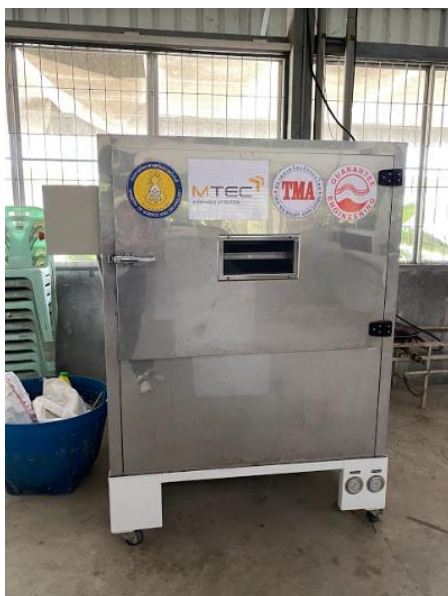
ภาพที่ 6.1.12 เครื่องเครื่องอบแห้งปั๊มความร้อนประหยัดพลังงาน (4) ที่มา: วิสาหกิจชุมชนคนนิยมฟาร์ม
