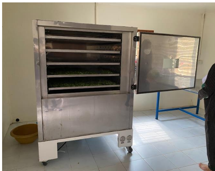
ภาพที่ 6.1.6 เครื่องเครื่องอบแห้งปั๊มความร้อนประหยัดพลังงาน (1)
