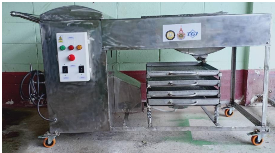
ภาพที่ 6.4.12 เครื่องผลิตเม็ดแป้งสาคุ (3)
