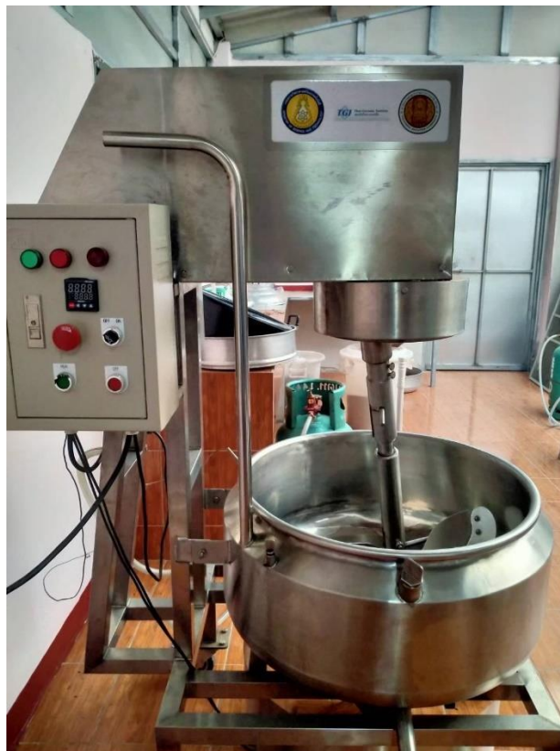
ภาพที่ 6.4.6 เครื่องกวนผลไม้ชนิดแกนหมุนแนวตั้ง (3)
