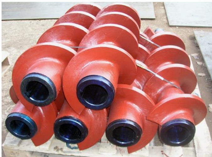
ภาพที่ 6.1.23 สกรูเพิ่มผลผลิตปาล์มน้ำมัน ที่มา: ผู้พัฒนา
