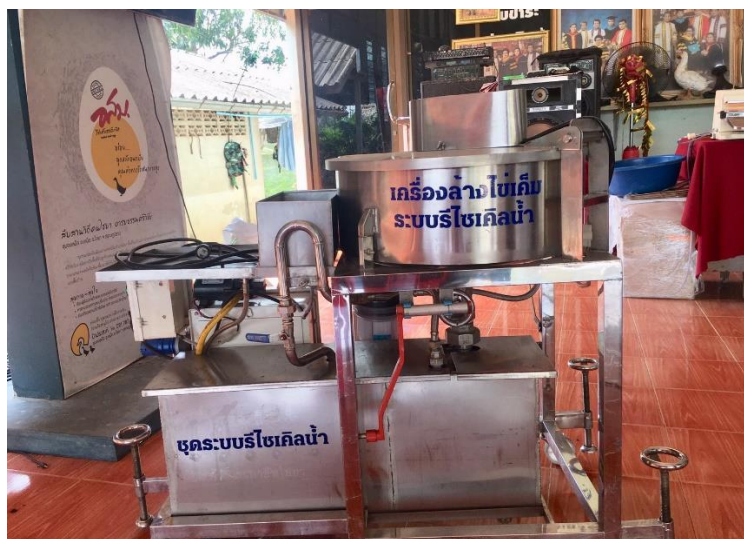
ภาพที่ 6.3.38 เครื่องล้างไข่เค็มระบบรีไซเคิลน้ำ
