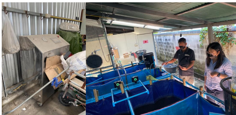
ภาพที่ 6.2.18 เครื่องคอนโตเลี้ยงสัตว์น้ำด้วยระบบไมโคร-นาโนบับเบิล ที่มา: ผู้พัฒนา
