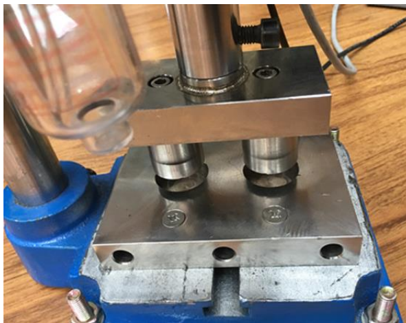
ภาพที่ 6.3.2 เครื่องขึ้นรูปขนมข้าวอัดแผ่น
