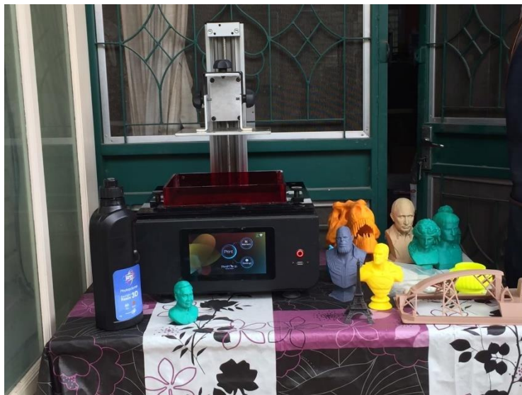
ภาพที่ 6.2.14 เครื่องขึ้นรูปชิ้นงานสามมิติความละเอียดสูงด้วยเรซินเหลว ที่มา: ผู้พัฒนา
