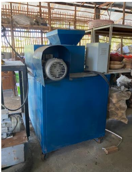
ภาพที่ 6.3.43 เครื่องบดเศษไม้ให้เป็นซีลี้อยแบบสองชุดบด ที่มา: วิสาหกิจชุมชนกลุ่มหัตถกรรมไม้มะม่วง ตำบลห้วยทราย
