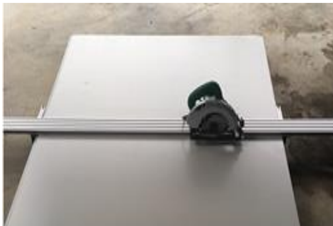
ภาพที่ 6.2.23 เครื่องตัดลบบคมแผ่นผนังห้องเย็น ที่มา: ผู้พัฒนา
