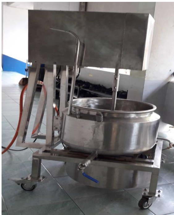
ภาพที่ 6.4.4 เครื่องกวนผลไม้ชนิดแกนหมุนแนวตั้ง (2)
