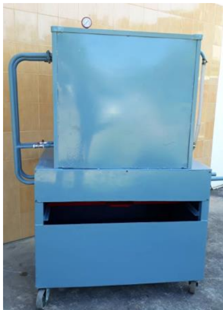
ภาพที่ 6.3.53 เครื่องอบความร้อนไอน้ำฆ่าเชื้อราเห็ดประสิทธิภาพสูง ที่มา: ศูนย์การเรียนรู้ฟาร์มหมูป่านเห็ดบึงกาฬ
