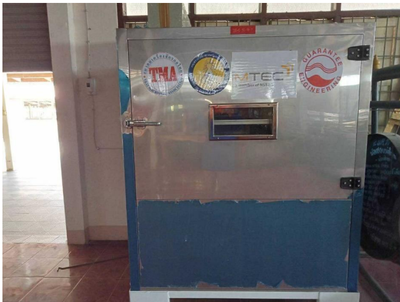
ภาพที่ 6.1.10 เครื่องเครื่องอบแห้งปั๊มความร้อนประหยัดพลังงาน (3)
