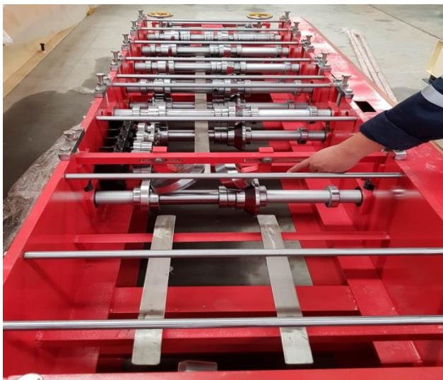
ภาพที่ 6.2.27 เครื่องรีดกรอบข้างแผ่นหลังคาเหล็ก
