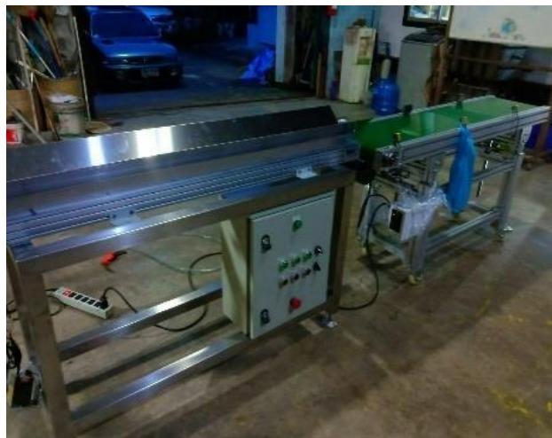
ภาพที่ 6.3.41 เครื่องัดขนาดหน่อพันธุ์สับประรดห้วยมุ่นระบบอัตโนมัติ ที่มา: ผู้พัฒนา
